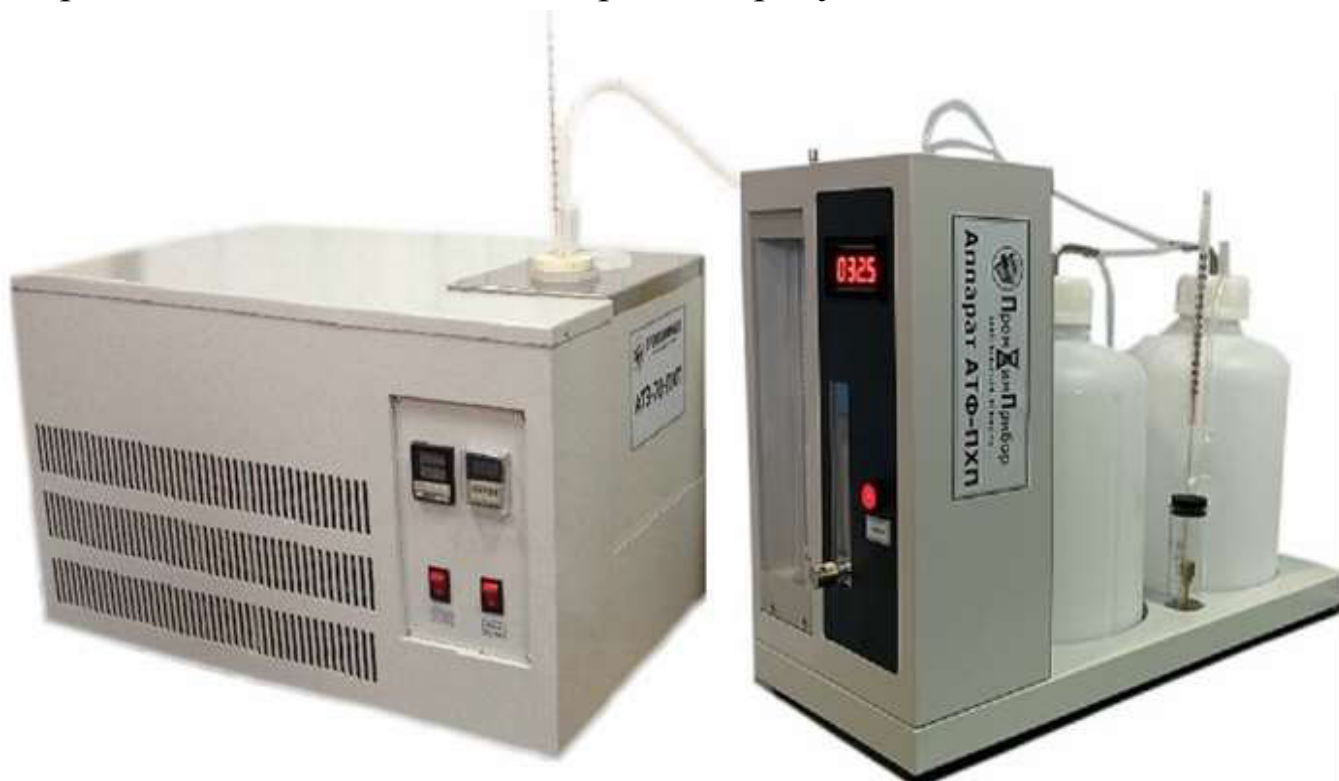
Рис. 1. Аппарат АТФ-ПХП в комплекте с АТЗ-70-ПХП
