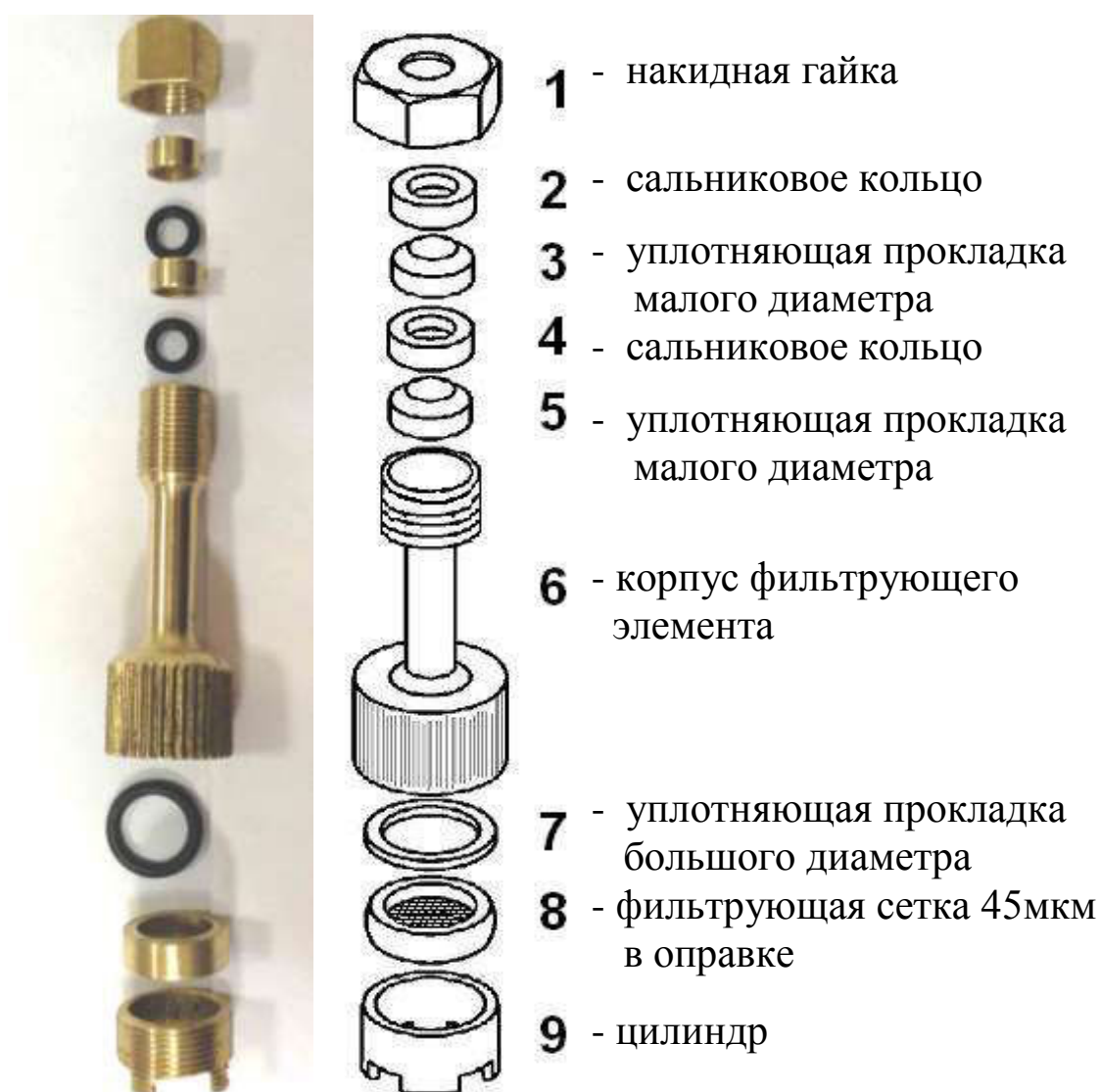
Рис. 11 Внешний вид и схема сборки фильтрующего элемента
