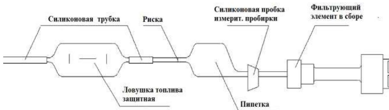
Рис. 10. Присоединение фильтра к ловушке для топлива
